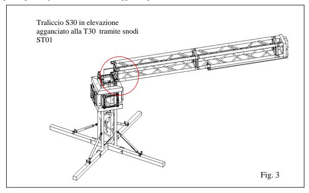
In particolare vengono posizionati 4 snodi (ST01) in acciaio alla testa della torre T30, di cui 2 già agganciati al traliccio in elevazione e i restanti smembrati ed in attesa di essere collegati tramite spine e fermi. (fig. 4).
