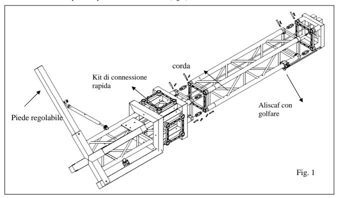
2) Prima dell'innalzamento in verticale della torre si posiziona la corda del verricello manuale necessario per il sollevamento dell'eventuale struttura in elevazione. In particolare si fa passare la corda all'interno dei tralicci e fin sul top di sollevamento bloccandola all'estremità tramite aliscaf con golfare. (fig. 1B)
